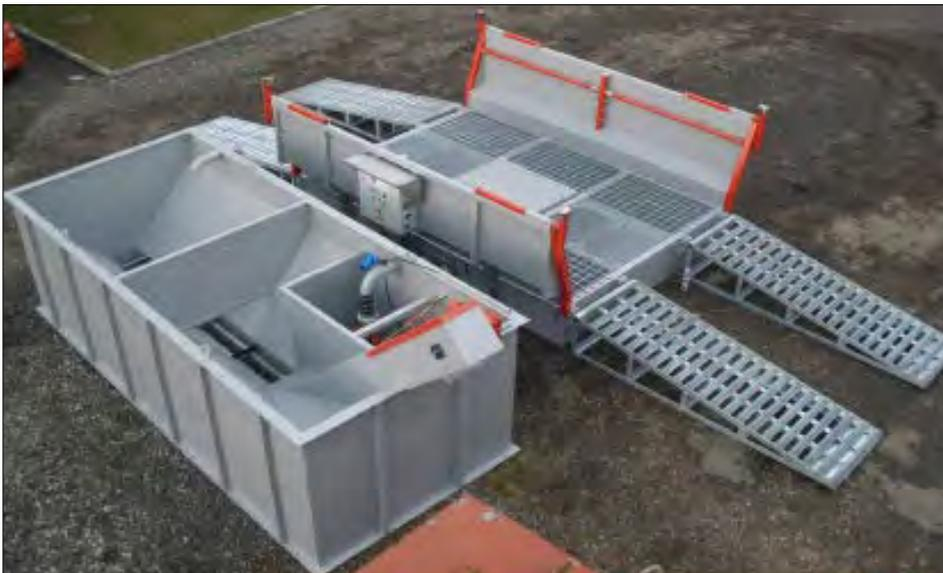
*Foto 3:* esempio impianto mobile lavaggio ruote
